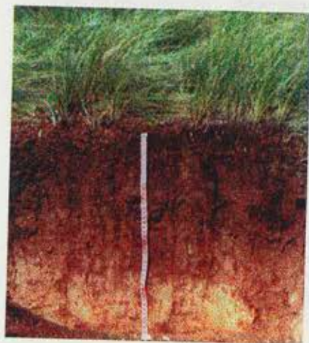
Разрез № 9806. Чернозем обыкновенный карбонатный малогумусный очень маломощный тяжелосуглинистый на элювии доломитизированных известняков, локальный эталон почв, Переволоцкий район
