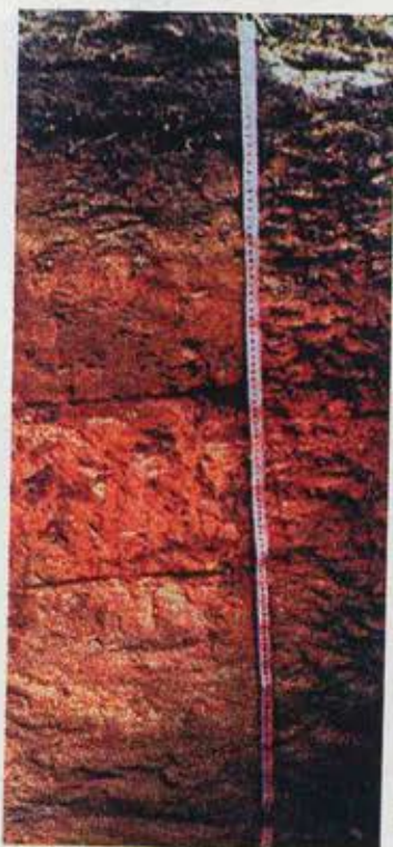
Разрез № 9815. Темно-серая лесная маломощная тяжелосуглинистая почва на делювиальных красновато-бурых легких суглинках, подстилаемых средними слоистыми суглинками (переотложенные коры выветривания), эталон исчезающих почв, Кваркенский район, памятник природы "Аландский бор"
